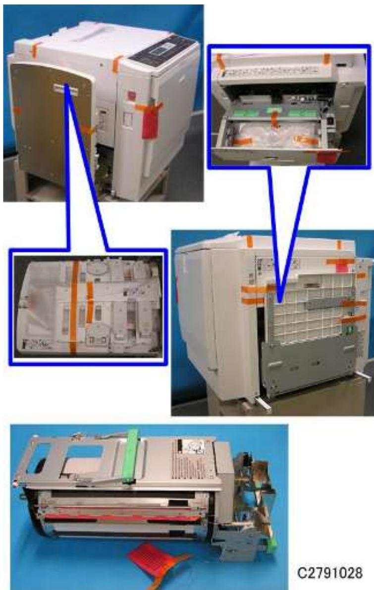
3. 如上所示，拆除固定盖板和单元的纤维胶带和细绳。
