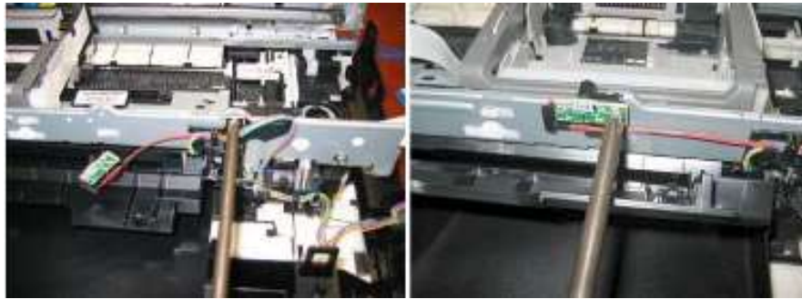
15) 安装 ASF 单元并安装 PE 传感器板组件。
