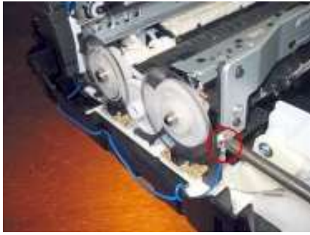
14) 将墨水传感器安装到前机架。
