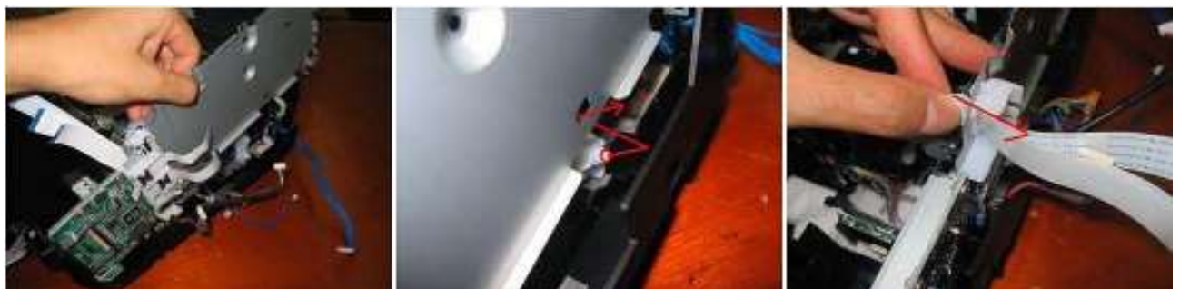
16) 安装主 PCB 机架。
