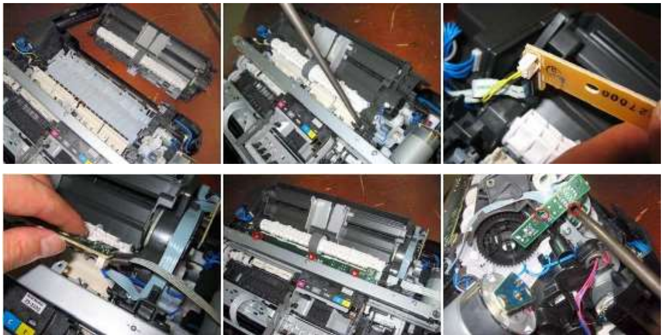
16) 安装主 PCB 机架。
