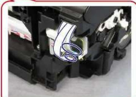
3. 释放一个锁键，并拆下 FFC 导槽盖。
