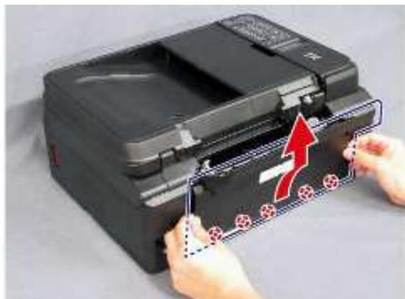
**(3) 拆下废墨垫套件（部分）。**
