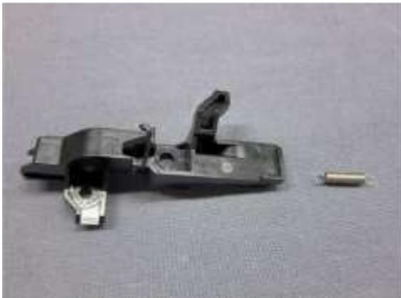
3. 拆下管接头上的 BK 和 CL 墨水管，然后拆下盖帽刮片单元。
