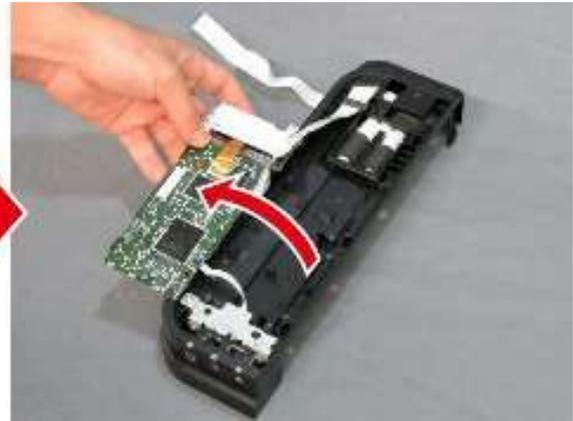
2. 断开面板 FFC，拆下磁芯，剥去双面胶带，然后拆下面板 FFC。
