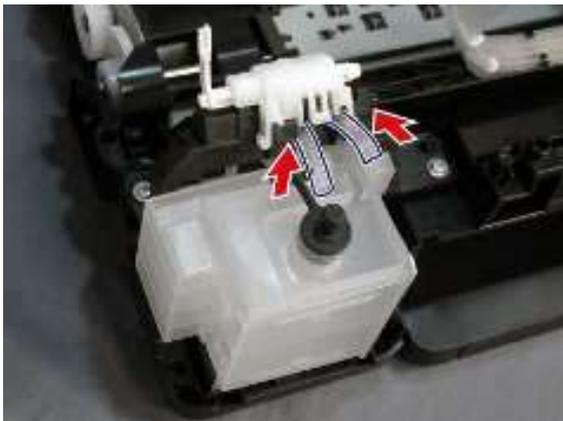
注释： 确保灰尘等没有附着在供墨管末端。（灰尘可能会妨碍密封性能）。
