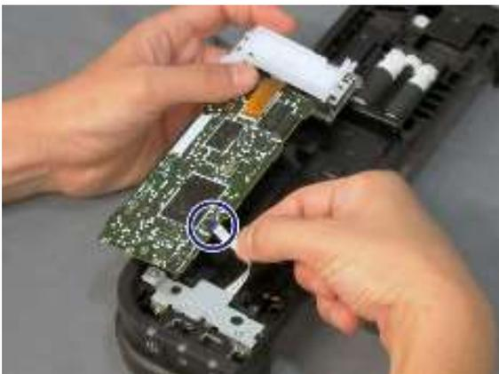
4. 拆下开关撑板的一个螺钉。
