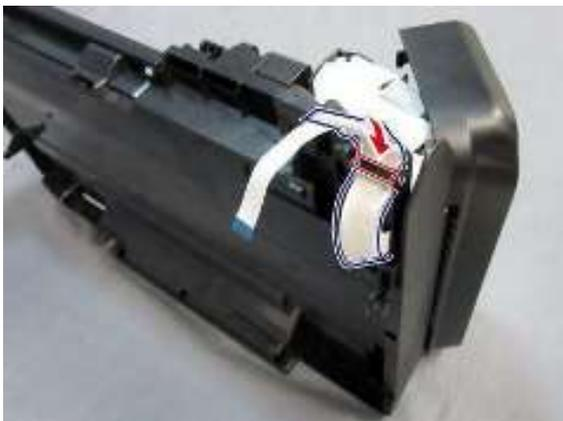
6. 拆下两个凸耳，并拆下原稿送稿盖单元。
