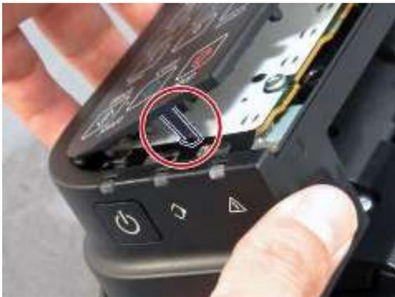
4. 拆下三个螺钉。翻转面板 PCB 组件，然后拆下原稿检测 FFC。
