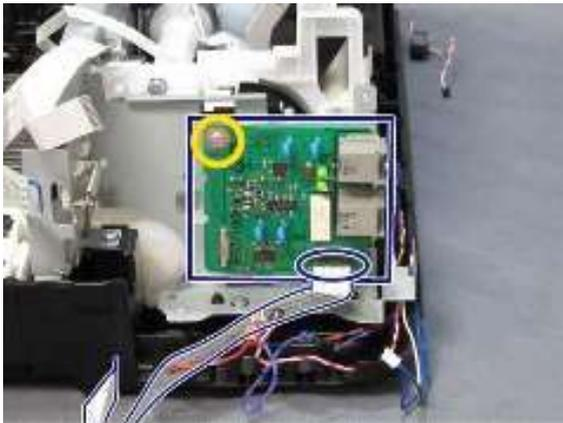
(21) 拆下进纸编码器 PCB 组件和光栅盘。
