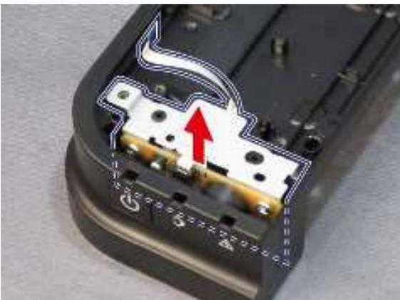
7. 拆下两个螺钉，分离电源开关 PCB 与开关撑板，并断开电源开关 FFC。
