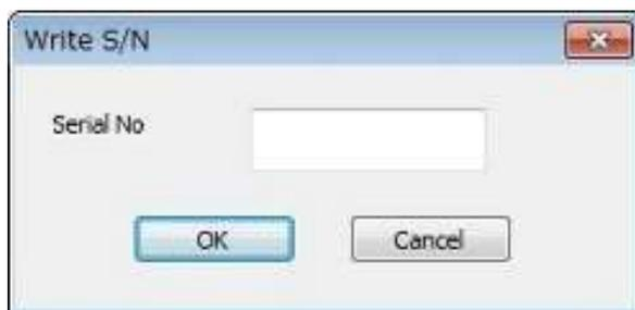
3. 在 **Service Tool > Main tab > Operation**（**维修工具 > Main 标签 >操作**）部分中，点击[EEPROM Save]（EEPROM 保存）。确认显示的序列号是否匹配打印机上的序列号，然后不保存关闭窗口。
