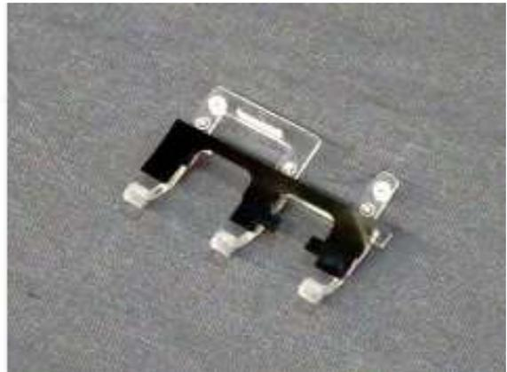
6. 拆下包括开关撑板在内的开关 PCB 组件。
