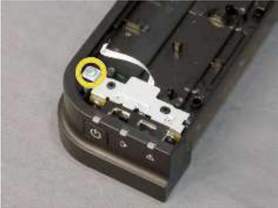
5. 拆下 LED 导板。
