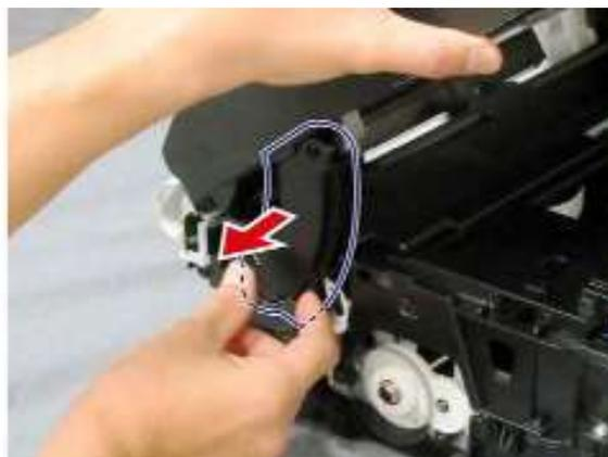
2. 拆下三个 FFCs，释放两个凸耳，然后拆下原稿送稿部件和扫描仪单元。
