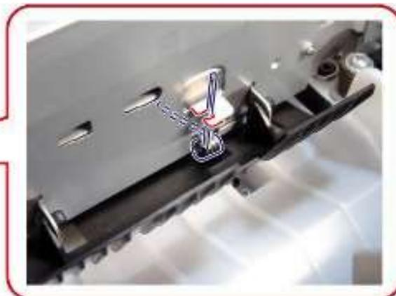
6. 拆下一个螺钉和释放两个锁键。滑动纸张设置传感器支架，以将其拆下。
