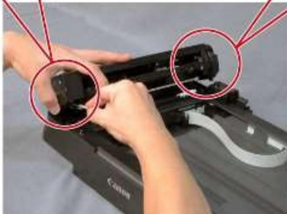
3. 拆下两个螺钉，释放三个锁键，然后拆下面板盖。
