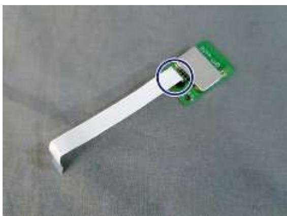
**(18) 拆下后部继电器 PCB 组件、继电器 PCB FFC、ADF 马达束线组件和进纸编码器 FFC。**
