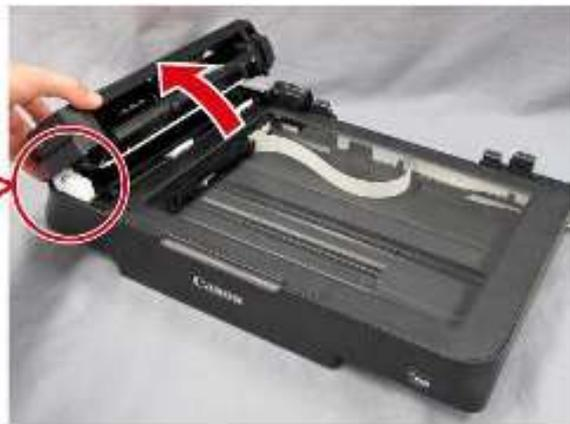
2. 释放一个固定钩 (1) 和脱开部分 (2)，然后完全打开原稿送稿盖单元。
