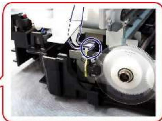
4. 拆下纸张末端束线组件、三个小车 FFCs、纸张设置 FFC 和 FFC 导板上的多个 FFC。
