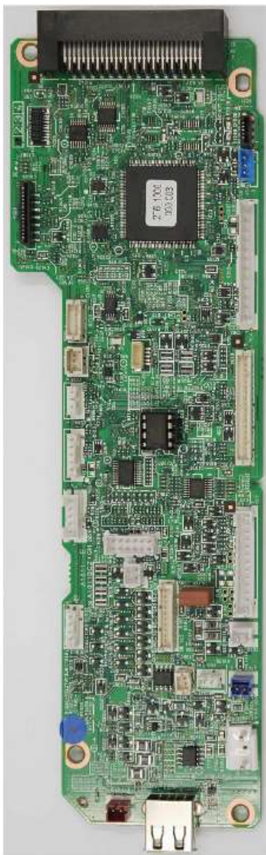
图 2-3-2 驱动板丝印图和照片
