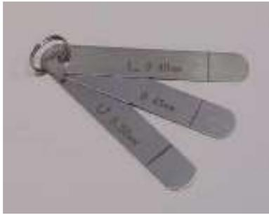
**刮刀-磁辊间隙调整夹具**
