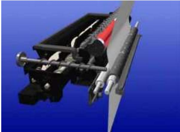
定位辊上加载 600V 偏压，使定辊能有效清除纸屑，提高并改善循环墨粉回收系统的可靠性。
