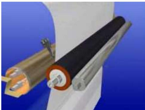
定影辊壁厚 0.8mm, 内有 2 个卤素加热灯, 各 564W, 上部为中心加热灯, 下部为侧加热灯, 这种设计加热效率高。
