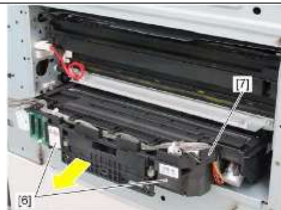
6、手指按住支架[6],将激光单元[7]向左轻轻移动 注意安装时不要碰触或损坏扁线接口
