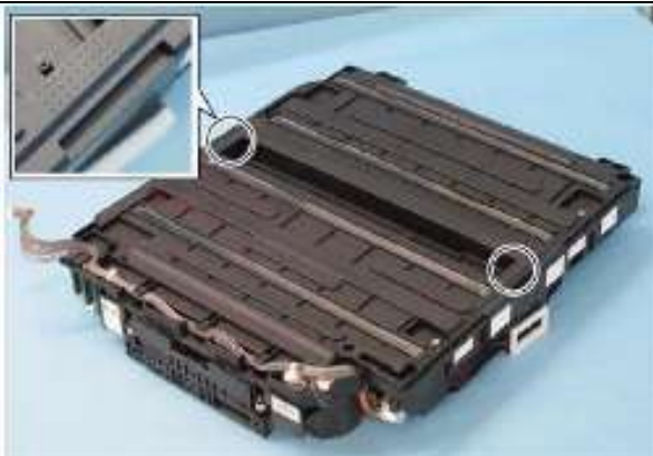
请握住激光单元的中间位置。注意不要用手指弄脏激光单元狭缝玻璃。注意不要让激光单元受撞击。现场不要拆装激光单元。
