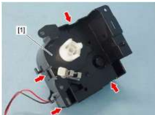
3、松开四处卡扣，拆下盖板[1]
