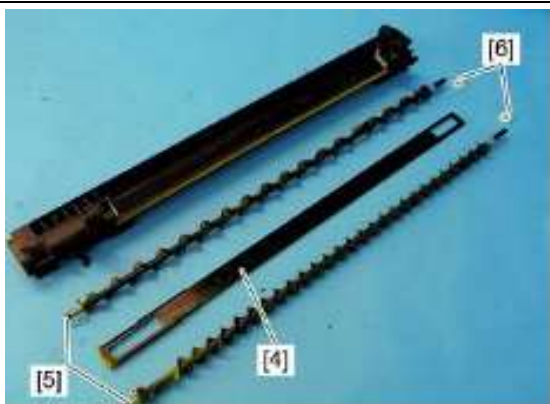
3、从前侧拆下分离垫片[4]、搅拌杆[5]和轴套[6]
