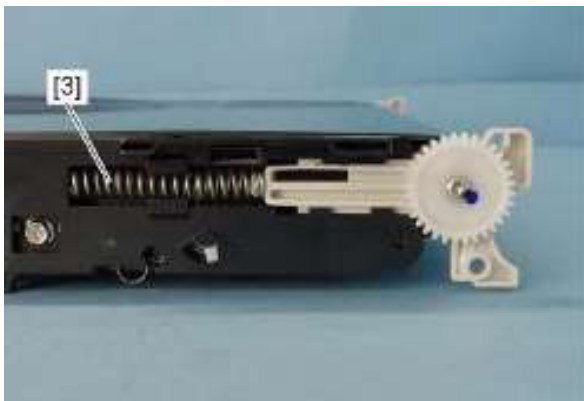
3、拆下后侧弹簧[3]
