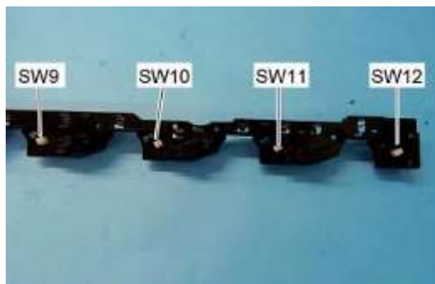
EPU新旧检测开关Y (SW9)、M (SW10)、C (SW11)、K(SW12)
