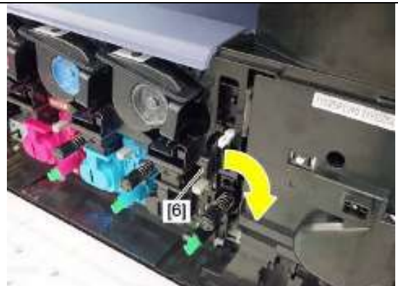
2、翻下转印带连接释放把手[1]，并顺时针旋转以释放第一转印辊
