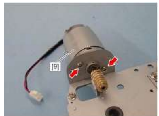
8、拧下两颗螺丝，拆下压力辊连接/释放电机[9]
