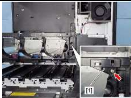
6、拧下1颗螺丝，拆下开关支架[1]
