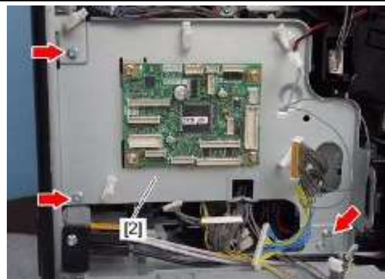
4、拧下 3 颗螺丝，拆下支架[2]
