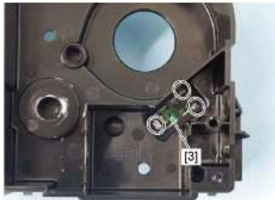
4、松开三处卡扣，拆下第二纸盒纸量传感器[2]
