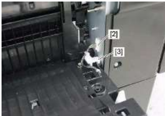
2、断开1个连接[2]，取下限位器[3]
