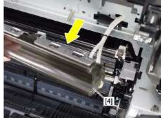
8、拉出线束，拆下IH线圈[4]
