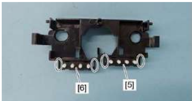
5、释放卡扣，拆下第二纸盒宽度检测开关[5]和第二纸盒长度检测开关[6]
