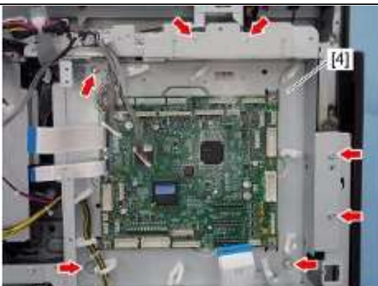
7、拧下七颗螺丝，向右滑动拆下 LGC 板支架[4]
