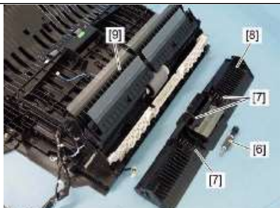
9、拆下旁路分离辊[6]，3 个弹簧[7]，下纸张导板[8]，上纸张导板[9]
