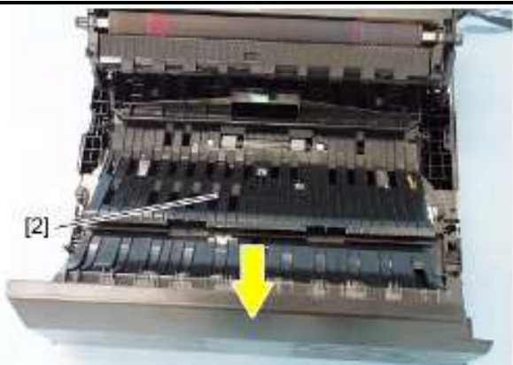
6、滑动并拆下 ADU 导板组件[2]
