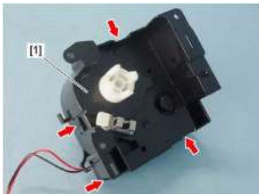
2、松开四处卡扣，拆下盖板[1]
