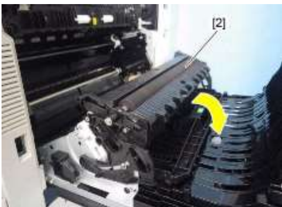
3、打开侧盖板，放下第二转印单元[2]
