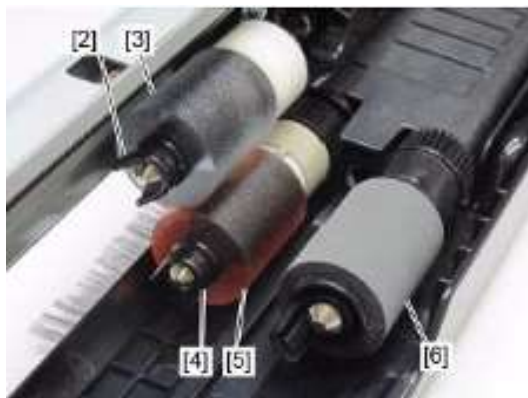
3、取下卡扣[2],拆下分离辊[3],取下卡扣[4],拆下进纸辊[5],释放搭扣取下搓纸辊[6]
