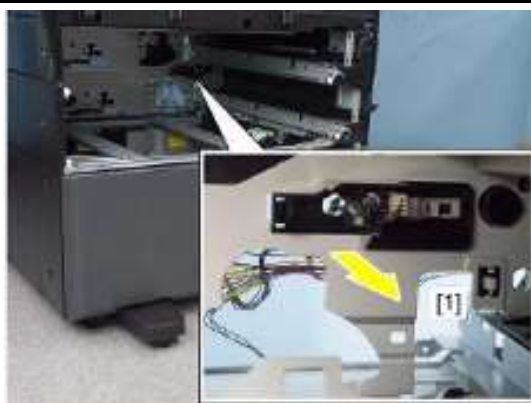
5、向后侧推出传感器支架[1]并取下
