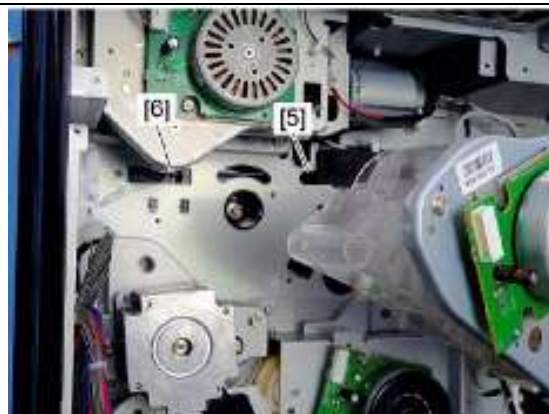
注意安装时要确认转印带驱动轴释放臂杆[5]卡入孔[6]
