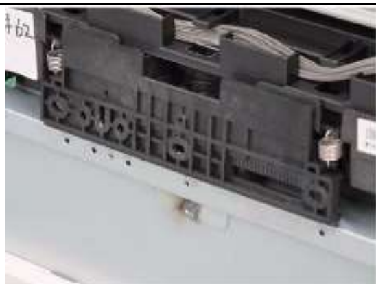
注意：处于移出状态的激光单元固定支架
