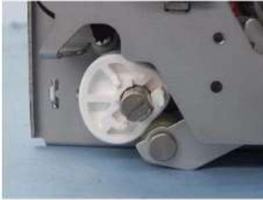
注意：压力连接/释放凸轮调节至图中释放位置
