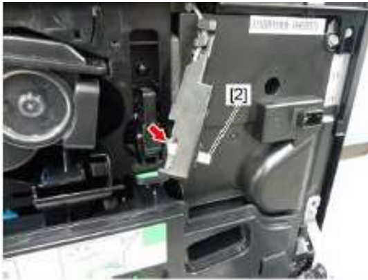
3、断开一个连接线束并取下前盖板开关[2]
