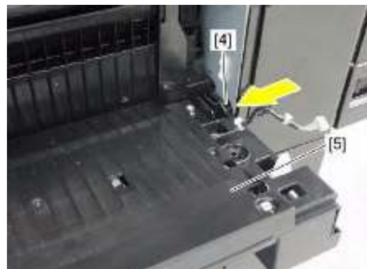
3、超前侧方向，压下后侧铰链，拆下卡纸排除盖板[5]
