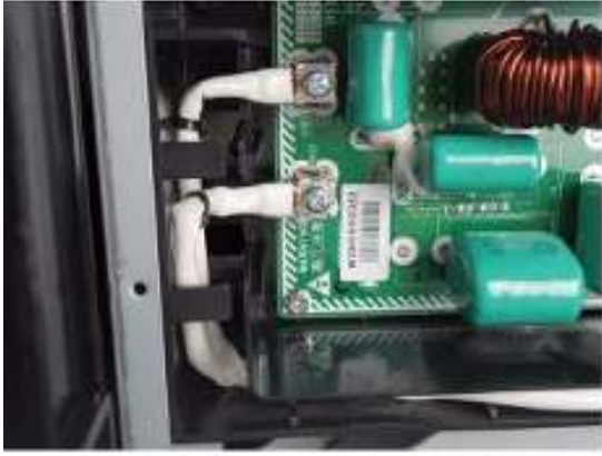
注意：安装时，保证线束处于图中水平位置，并保证螺丝拧紧
