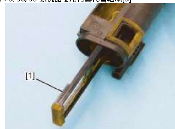
注意：安装分离隔板时，注意将短的一侧朝左侧
