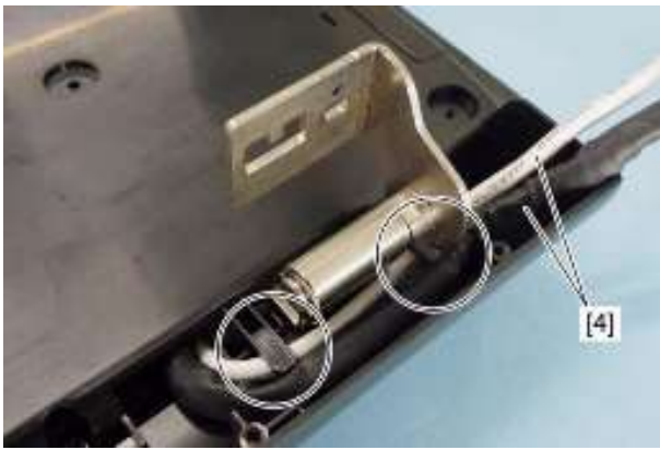
8、从线束夹中取出 USB 线束和信号线束[4]。
