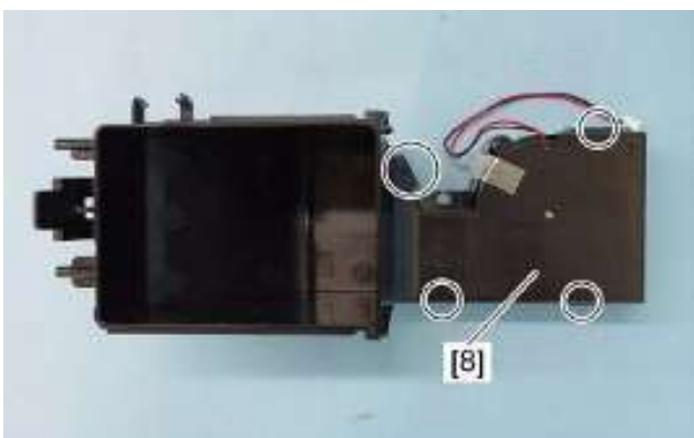
10、释放 4 个卡扣并拆下臭氧出气风扇风道盖板[8]
