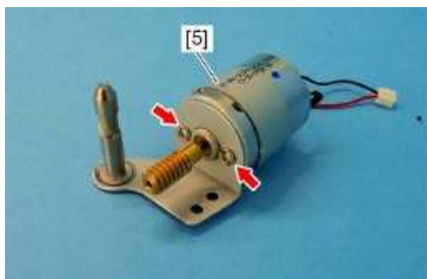
5、拧下2颗螺丝并拆下加粉电机[5]
