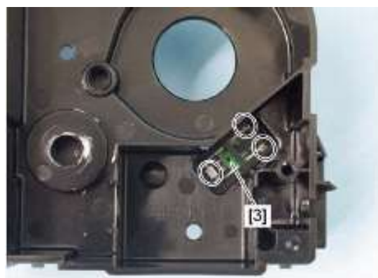
4、释放 3 个卡扣，拆下第一纸盒纸量传感器[3]
