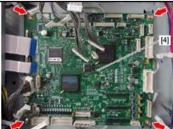
4、拧下 4 颗螺丝并拆下 LGC 板[4]
