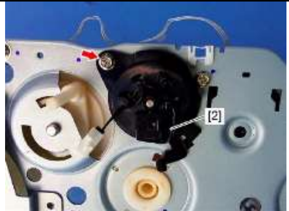
4、拆下 1 转连接/释放离合器 ( CLT2 ) [2] 参考 “7.11 1 转连接/释放离合器”
