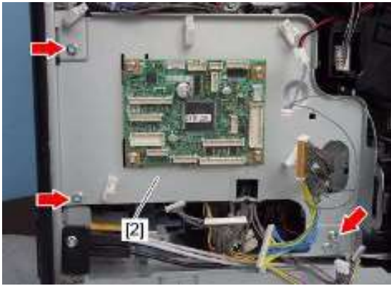
4、拧下 3 颗螺丝，拆下支架[2]
