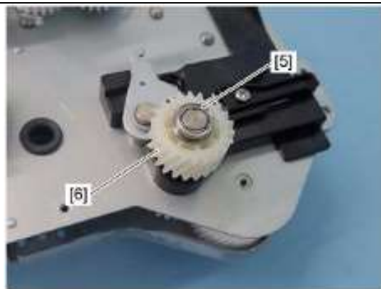
5、拆下轴承[5]，齿轮[6]和定位销
