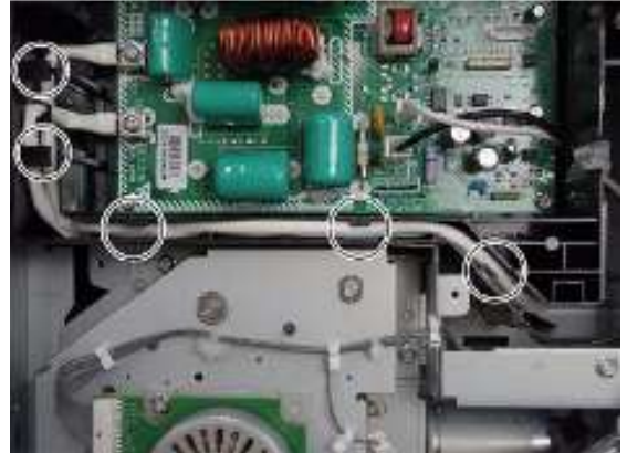
安装时注意 IH 板线束的走线
