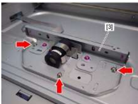
3、拧下三颗螺丝，取下CCD透镜单元[3]。注意：A、CCD透镜单元属于精密仪器，无法在场地上进行光学调整
