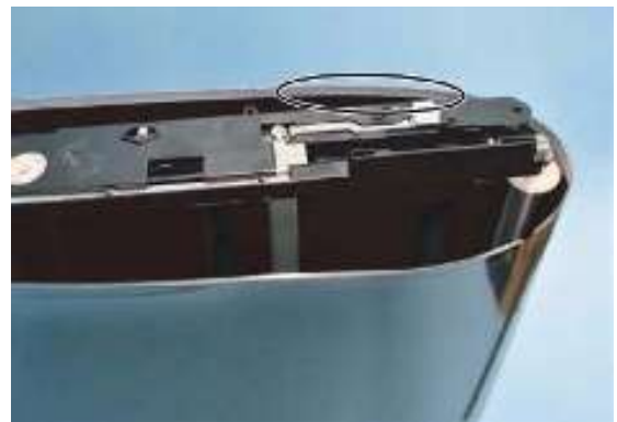
注意：安装转印带时，注意要保证有序列号的一侧置于复合机前侧
