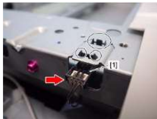
3、断开线束，松开三处卡扣，取下扫描架初始位置传感器[1]。
