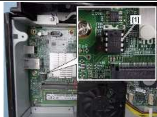
3、从 SYS 板上拆下 SRAM 芯片
