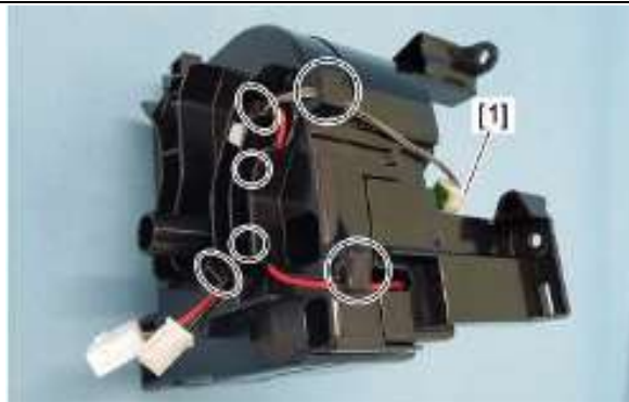
2、从线束扣中释放线束，并断开 1 个连接[1]
