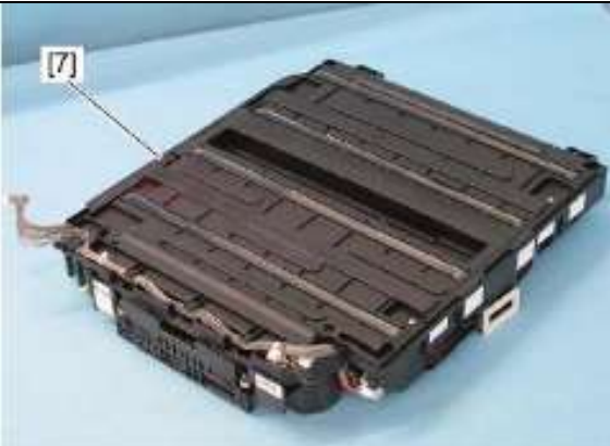
7、拆下整个激光单元[7]
