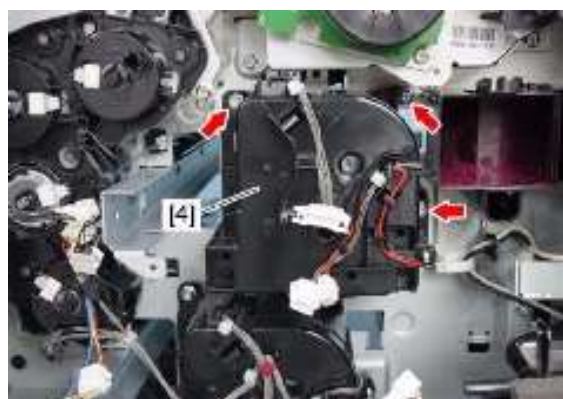
7、拧下 3 颗螺丝并拆下第一托盘抬升电机单元[4]
