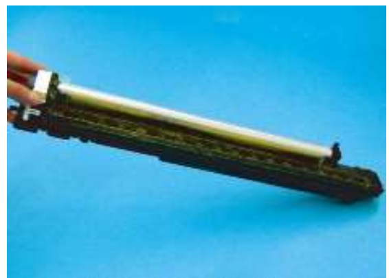
4、提起显影仓后侧使得载体沿着显影套筒向前侧移动
