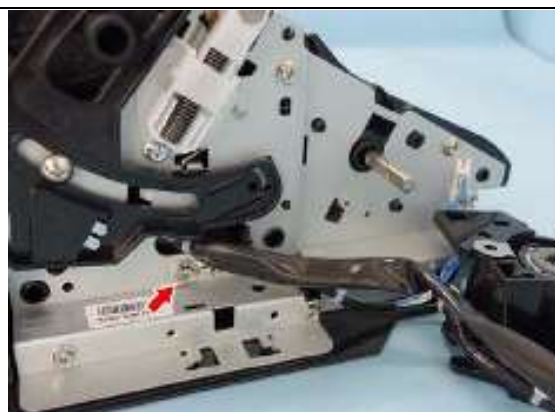
5、拧下 1 颗接地线的螺丝
