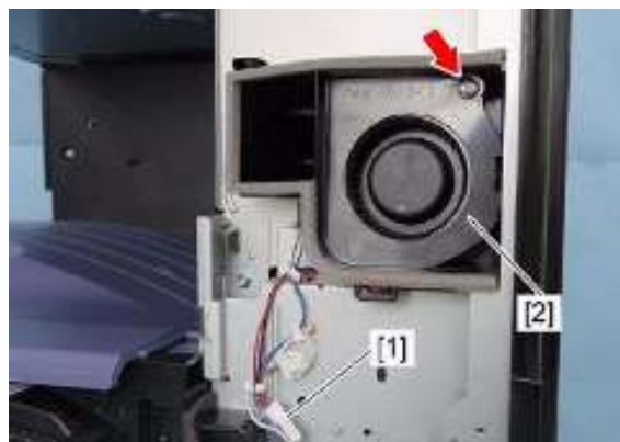
2、断开 1 个连接[1], 拧下 1 颗螺丝, 拆下风道[2]
