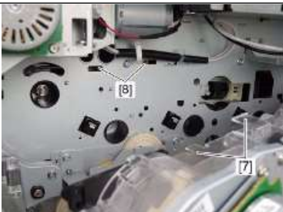
注意安装鼓转印驱动单元时，单元卡扣[7]要卡入支架孔[8]内
