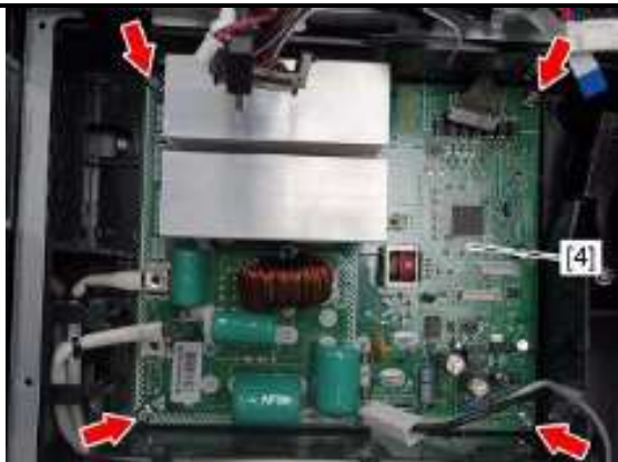
5、拧下 4 颗螺丝并拆下 IH 板[4]
