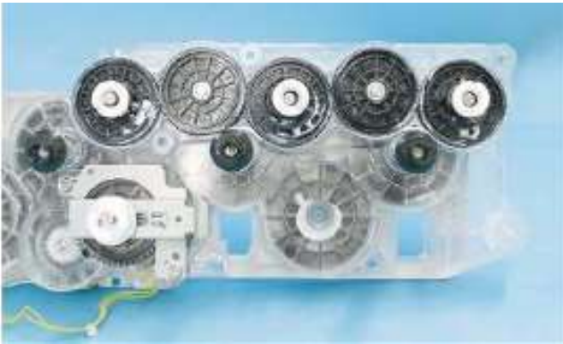
3、拆下显影驱动齿轮
