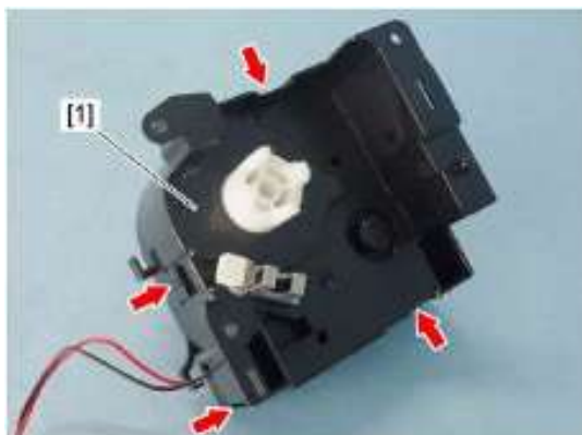
3、松开四处卡扣，拆下盖板[1]
