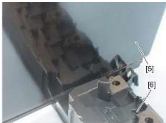
5、使用新转印带的包装材料和废粉盒[6]作为支撑，立起转印带单元[5]
