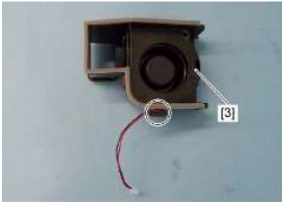
3、从线束扣中释放线束，拆下出口冷却风扇[3]
