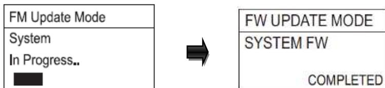
f、关闭电源，拆下 USB 存储设备。
