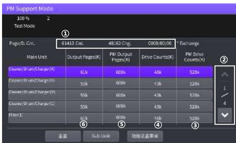
①、显示输出页数/显影页数/驱动次数。选中 PM 组件/零件后, 可显示上一次更换此 PM 组件/零件的日期。按下[重置]可清零。当此 PM 组件包含子零件, 按下[SUB UNIT]可进入此 PM 组件所包含的子 PM 零件的界面。
