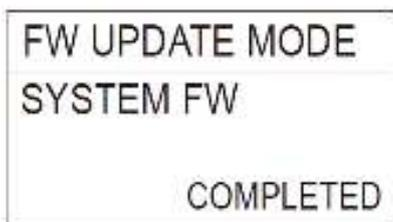
6. 0+8 开机，输入 9030，按【开始】键，然后按下【确定】键，执行软件初始化。
