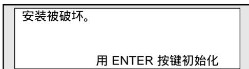
含义 接通电源时安装区域的校验和内容被破坏。
