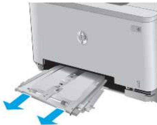
3. 轻轻地将所有卡纸从单张先进纸槽中直接拉出。
