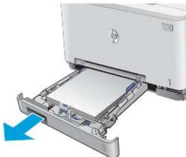
2. 向下推单张先进纸槽, 然后拉出进纸槽托盘。
