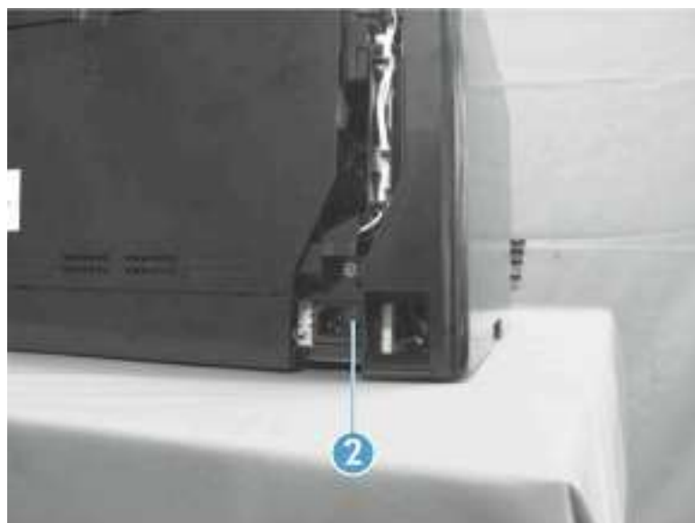
图 1-17 拆卸左盖（第 3 步，共 4 步）
