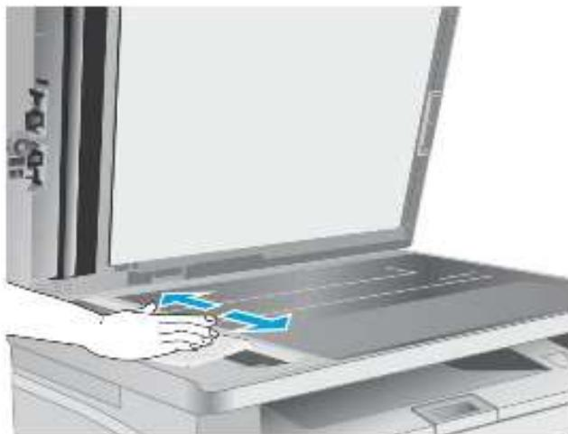
5. 重新安装薄膜组件。确保胶片滑到扫描仪机身两端的标签下方。
