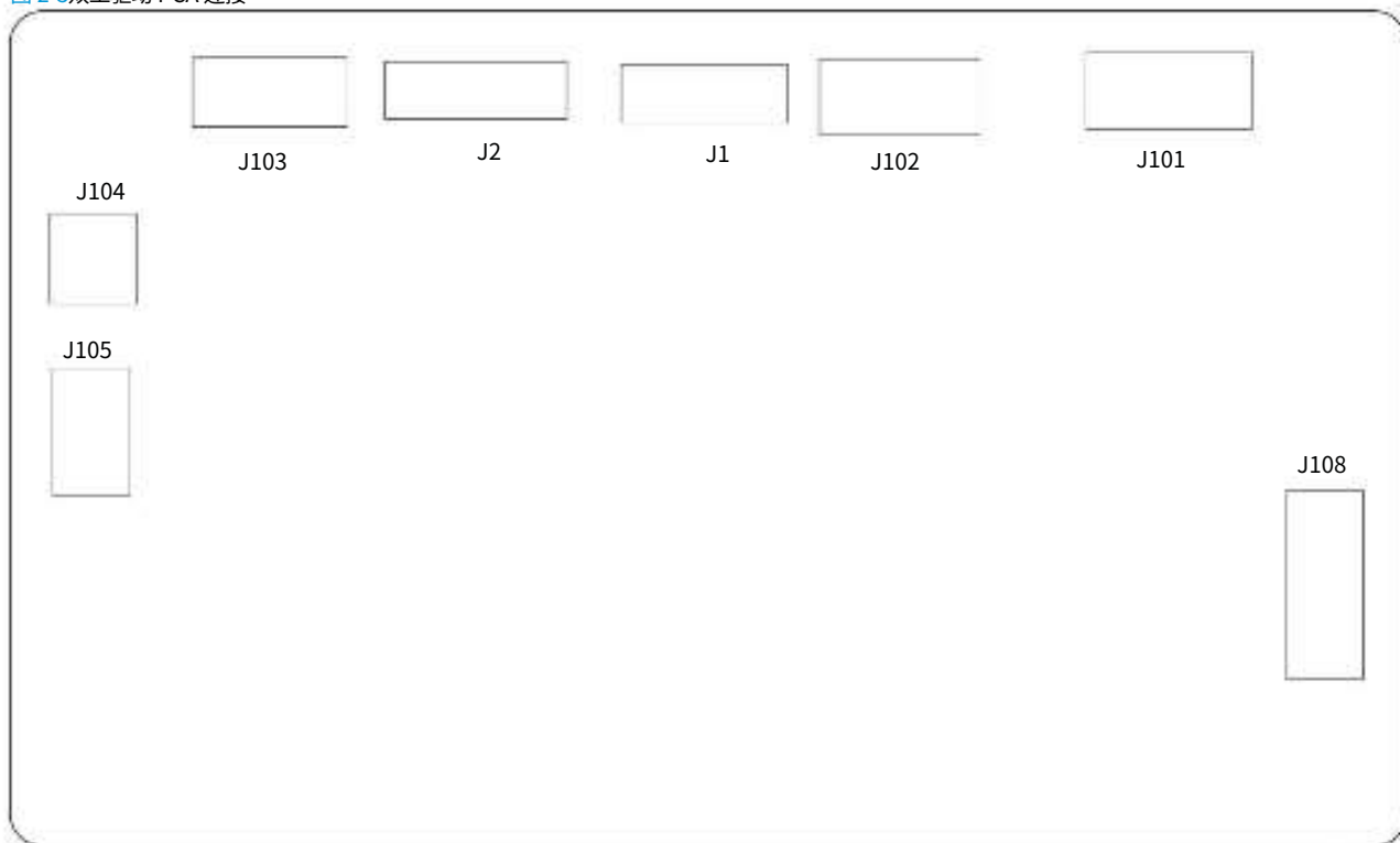
图 2-5 双工驱动 PCA 连接
