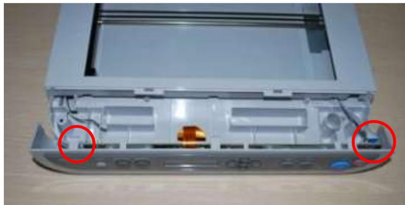
6. 拔掉 LCD 连接线。
