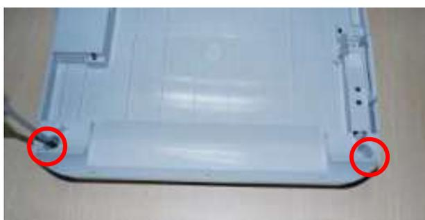
4. 取下螺丝后，松开固定卡爪，如图所示。
