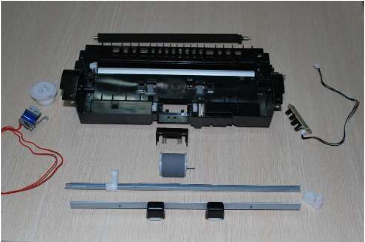
2. 拆下搬送组件后，顶开转印辊右侧的卡爪。
