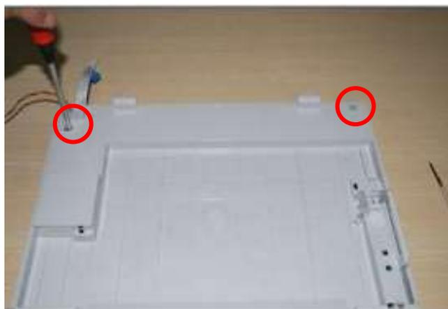
10. 松开固定卡爪，将玻璃稿台拆开。
