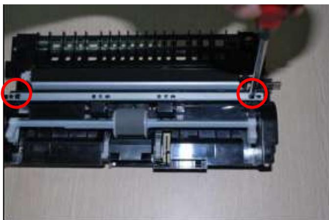
12. 将给纸轴组件左边凸轮固定卡爪松开，将凸轮往右推，取下给纸轴组件。
