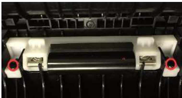
9. 拆除输稿器搬送轮。
